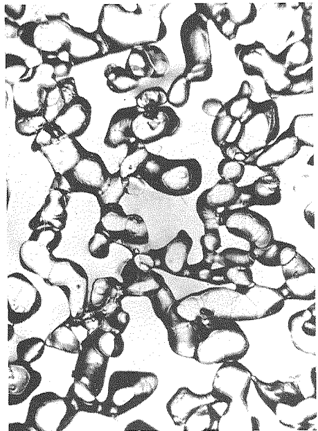
第2図 しまりゆき(雪試料)の薄片 密度 0.375 \text{ g/cm}^3
