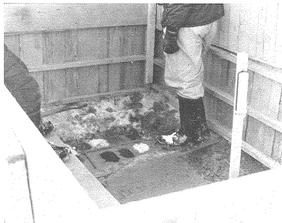
第2図 実験地。平滑にした地面の1部にいろいろな粉状物質が散布してある
