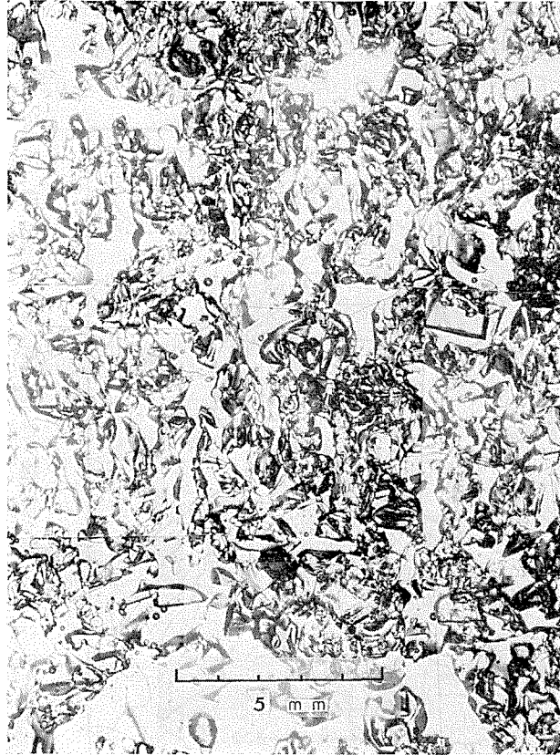
第3図 大雪山のアイスバーンの顕微鏡組織 写真上方が積雪の鉛直上方に当る
