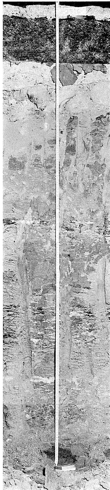
第6図 B室の凍土断面
