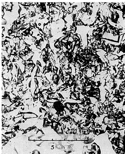
図 17 北海道旭岳のしもざらめ型硬化雪の組織 (昭和 44 年 3 月)
