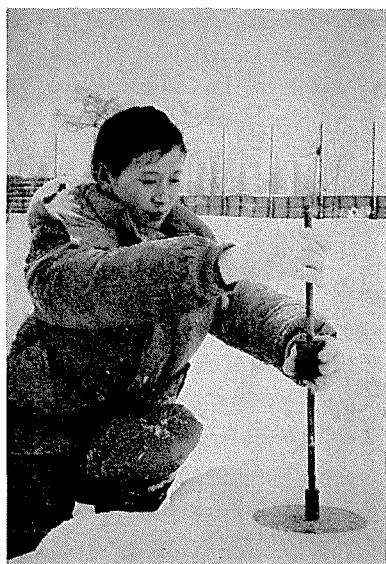
図 23 木下式硬度計による雪面硬度の測定
