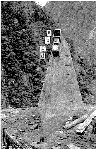
第5図 三角マウンド（志合谷宿舎跡の屋上）。a 16mmカメラ設置筐，b ロードセル，c 応力計，d 圧痕計（取付位置）
