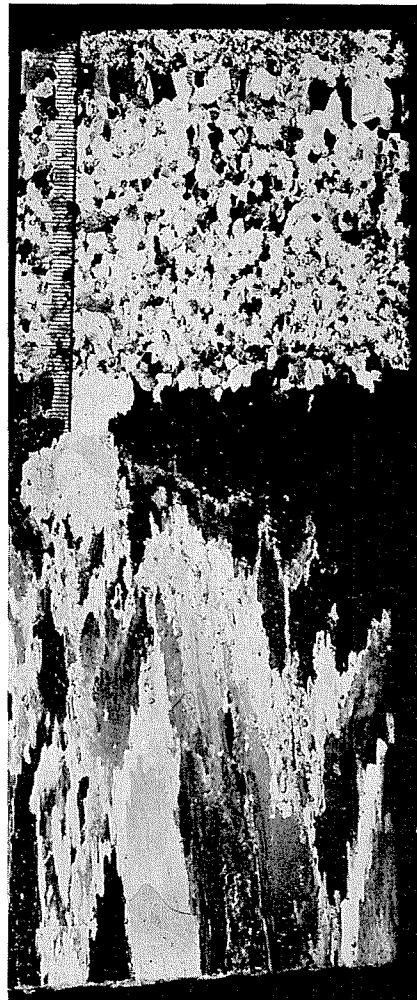
第2図 B 点の氷の垂直断面の偏光写真
