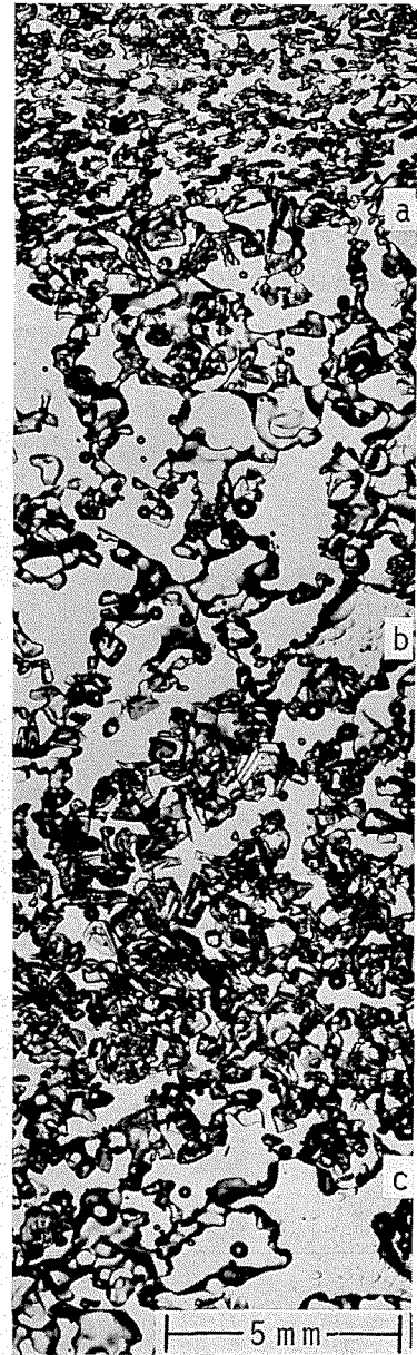
第5図 しもざらめ雪を含んだ鉛直薄片。bc間 (厚さ約1 cm) がすべり層
