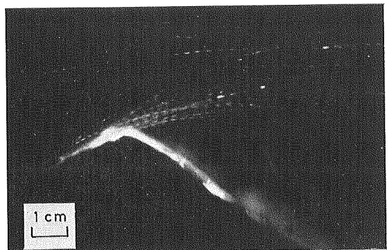
第 7 図 小さな斜面の周辺での雪粒子の運動。20 m/s の風を 5 m 離れた所から吹かせた。温度 -14^{\circ}\text{C}
