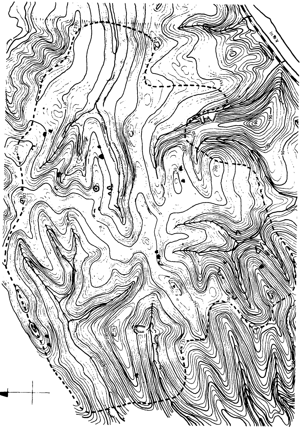
図版5 1974年3月3日～3月5日。前日(3月4日)は気温が上昇し雨となった。クラック(線部分)が多く発生しているのが目立つ
