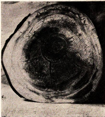
第4圖 カイメンタケによつて腐朽したトドマツ材の横断面
