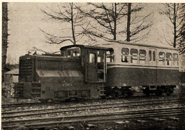
第 13 図 枝幸簡易軌道 日本輸送機 K.K. 製 B8 ton ディーゼル機関車 (運輸工業 K.K. 原図 1957)
