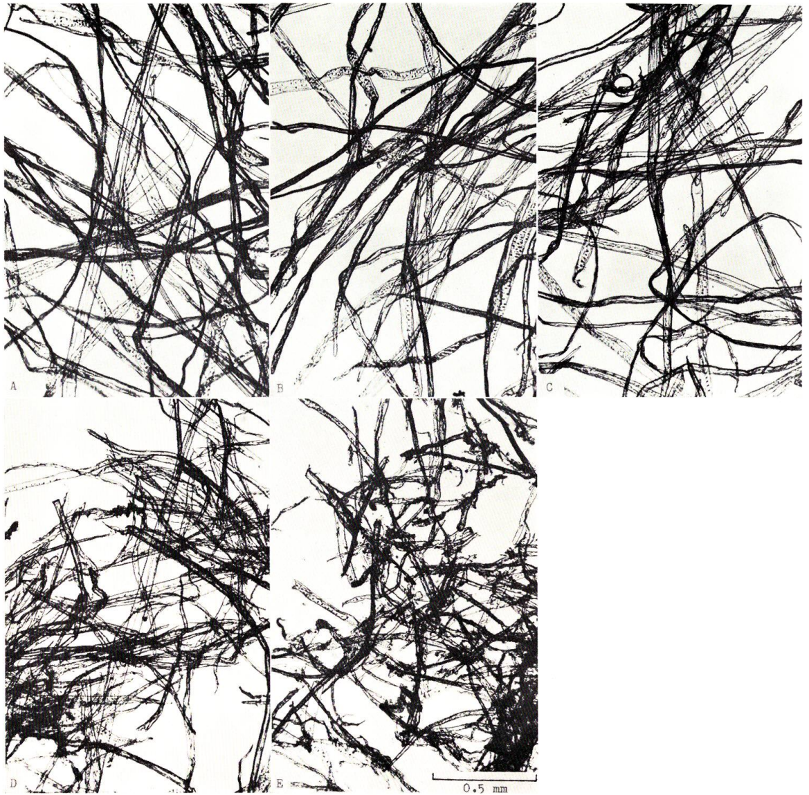
第70図 未叩解 No. 1 内パルプふるい分けの各フラクションの繊維 Fig. 70. Fiber of every fraction of No. 1 inner pulp unbeaten.
