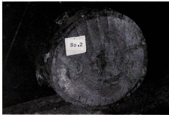
第14図 試料 No. 2 の新横断面の腐朽状態 Fig. 14. The appearance of new cross-section of sample No. 2.
