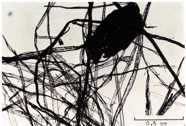
第45図 No. 5のパルプ中にみられる微細腐朽木片 Fig. 45. Fine decayed wood piece in No. 5 pulp
