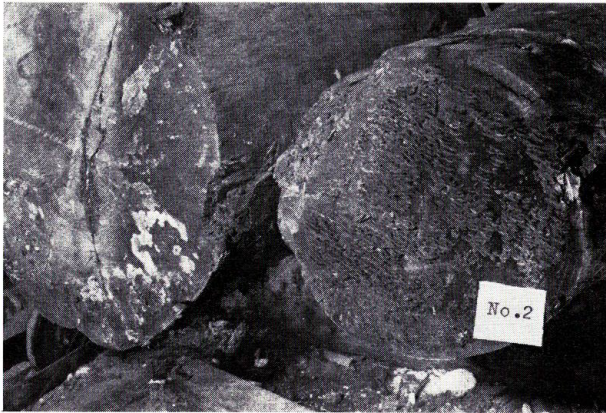
第13図 試料 No. 2 丸太の木口面に着生した子実体 Fig. 13. Sporophores of Fomitopsis roseo-zonata on the end of a sample No. 2 log.
