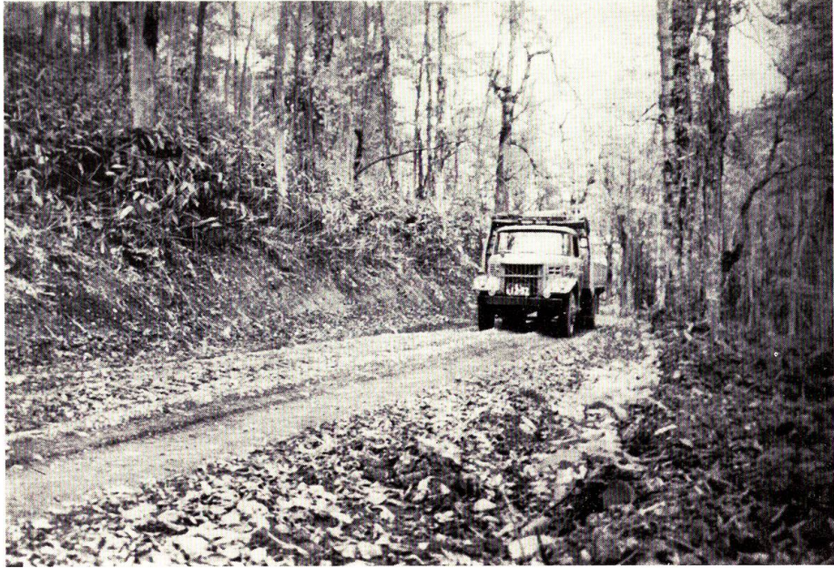
写真—5 路面沈下測定用車輛の通過状況
