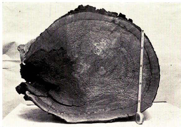
写真1. エゾヒズメタケによって腐朽したカツラ材の横断面
