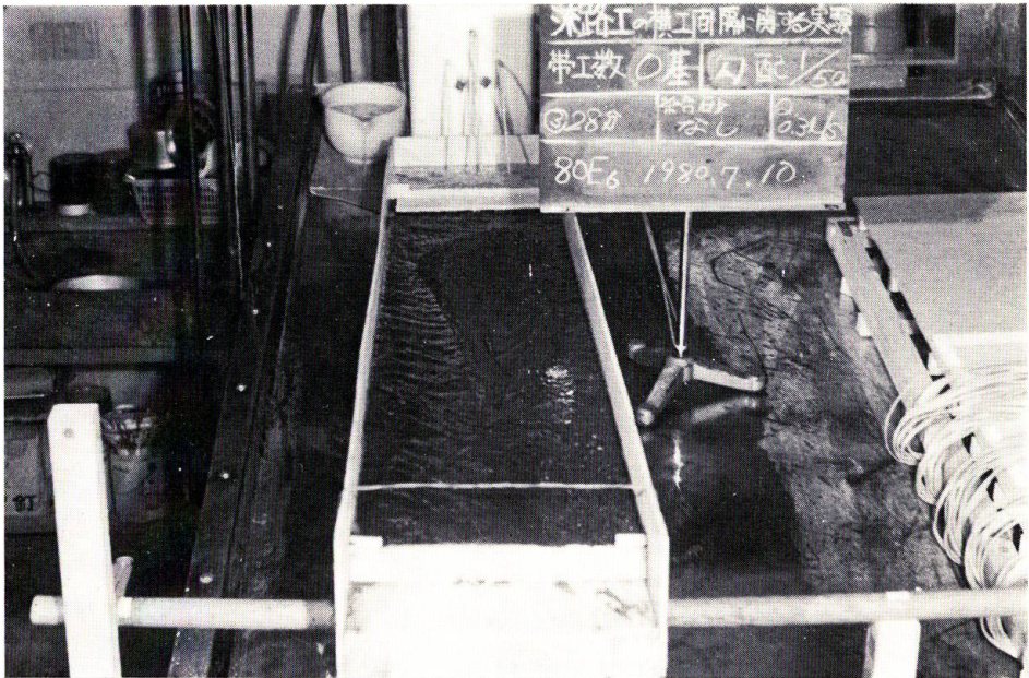
写真—4 実験ケース I。L/B=5.0 の流況。大規模な砂礫堆の水面上への突出。 D. c. = 18.0 \times 10^{-3}
