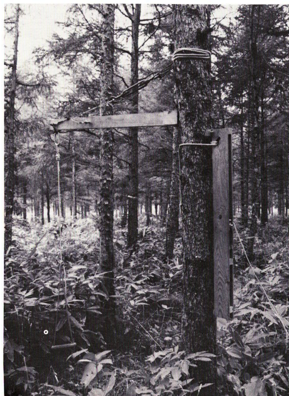
写真一2.3 加力梃子と矢高測定器の取付け Photo 2.3 Attachment of the device.
