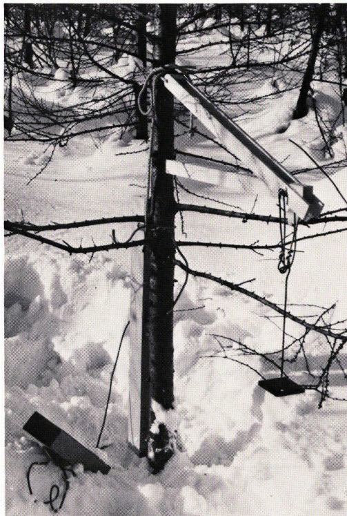
写真-3.1 小径木の曲げ剛性試験 Photo 3.1 Bending test for a small tree.
