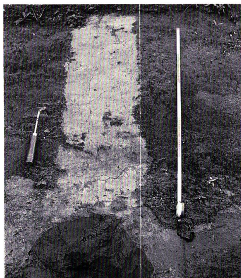
写真-4 Yt (勇知層) の層相 きわめて均質な非固結細粒砂岩である。位置は図-1 参照。
