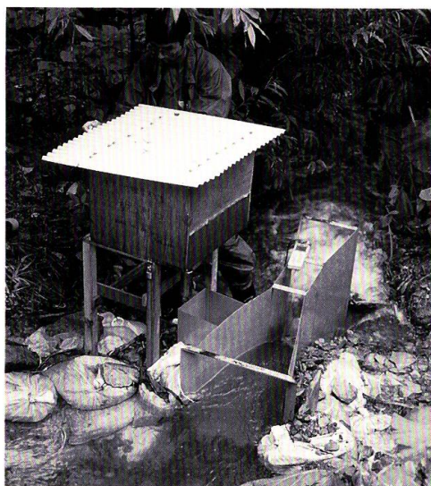
写真-8 流量観測状態 (洪水時の例, Wk 流域) 手前が上流側。洪水流がすべてパーシャルフリュウムの中を流れていることに注意。位置は図-2 参照。
