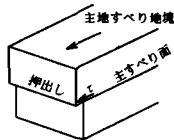
主すべり面のせん断破壊による押し出し
