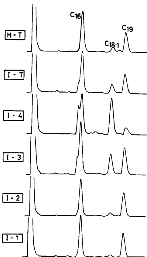
図-7 脂肪酸メチルエステルのガスクロマトグラム SE-30 5% on Chromosorb W-AWCS, 60~80 メッシュ, 3 mm×75 cm. 昇温 170°~210°, 毎分 2° キャリアー: ヘリウム, 毎分 20 ml
