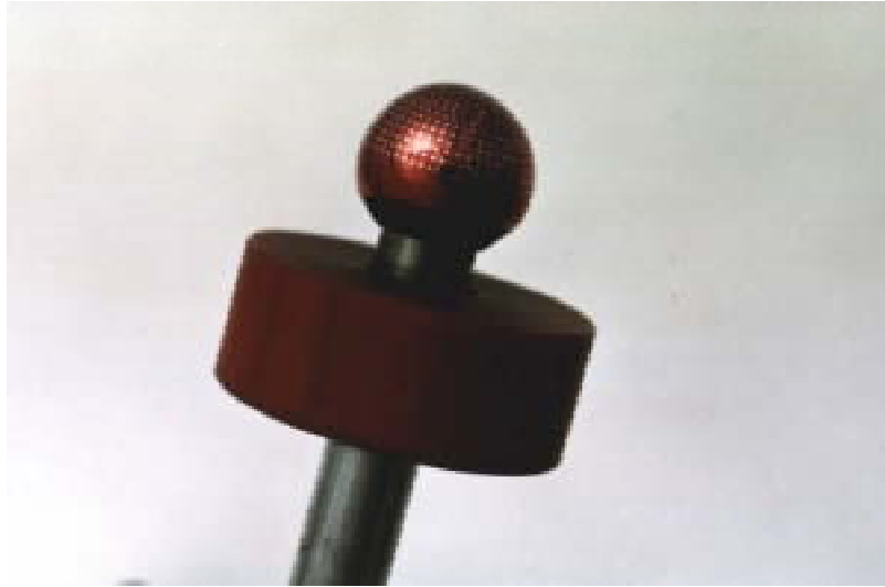
図 3-1 レジストを塗布し現像した状態の骨頭
