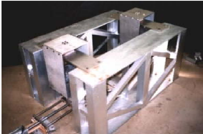
図 4-3 振り子式人工関節シミュレータの外観写真
