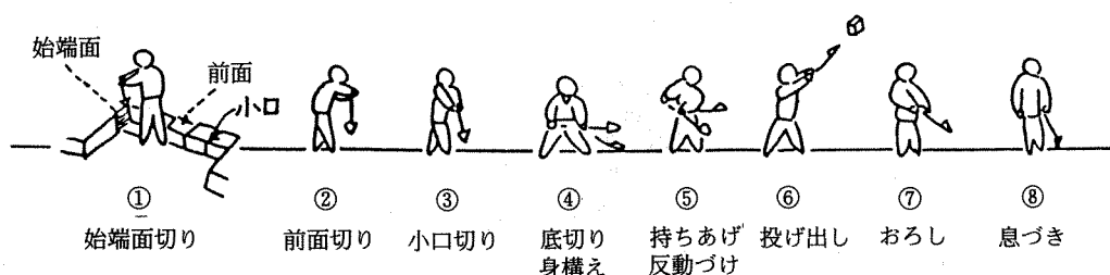
図 1-1 1 とシャベル 1 投雪の動作分解図 (古川, 1963による)
