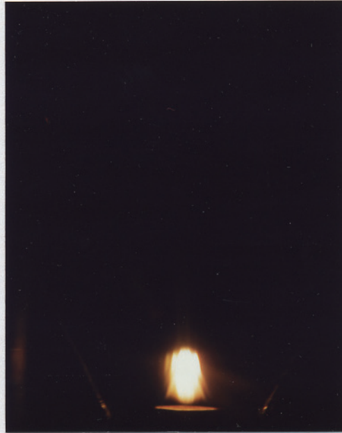
図7. 5 勾配磁場のある微小重力火炎 (バーナ内径6mm、燃料流量0.6mL/s、雰囲気酸素濃度50%)
