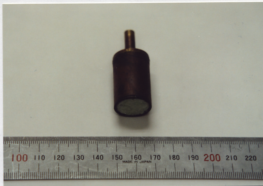
図4. 10 セラミックファイバマット挿入バーナ (燃料噴出口径18mm、セラミックファイバ厚さ15mm、空隙率54.8%)
