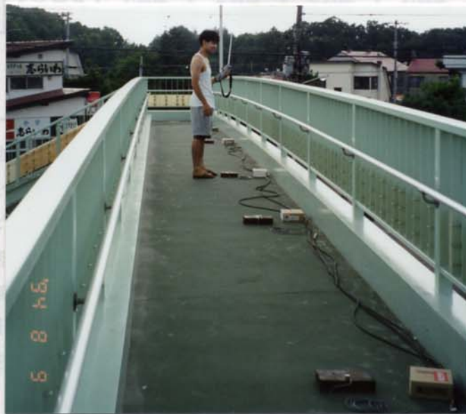
写真-5.11 実験風景（固有振動数測定）
