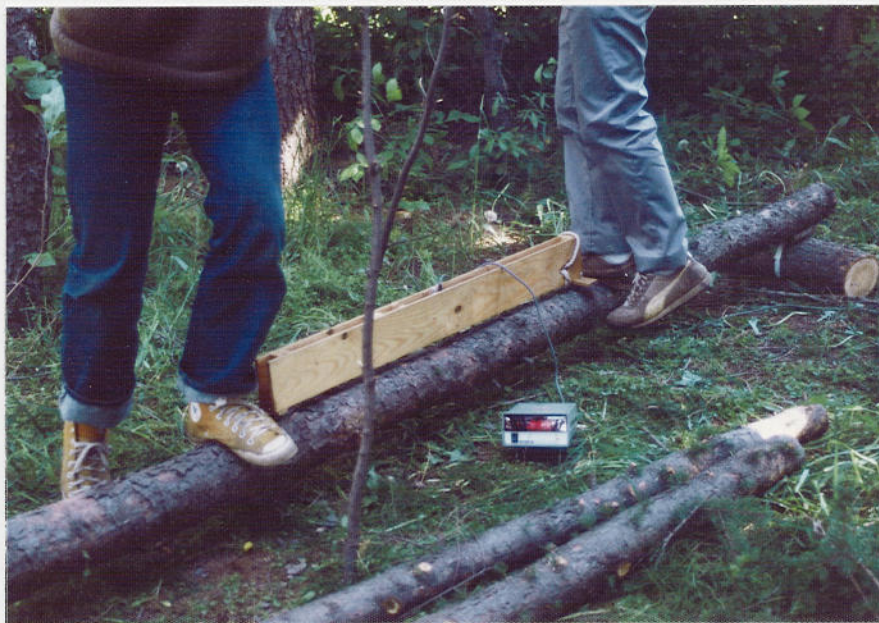
写真 4.1 屋外での丸太材の曲げ剛性試験
