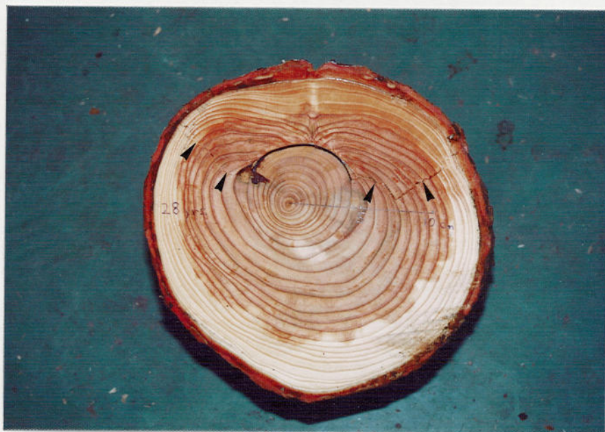
写真 6.7 半径応力による破壊部の断面
