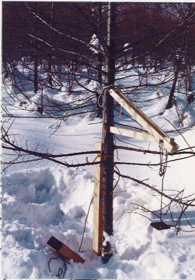
写真 3.1 小径木の曲げ剛性試験
