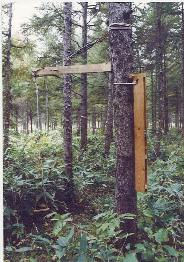
写真 2.3 梃子と矢高測定器の取付け
