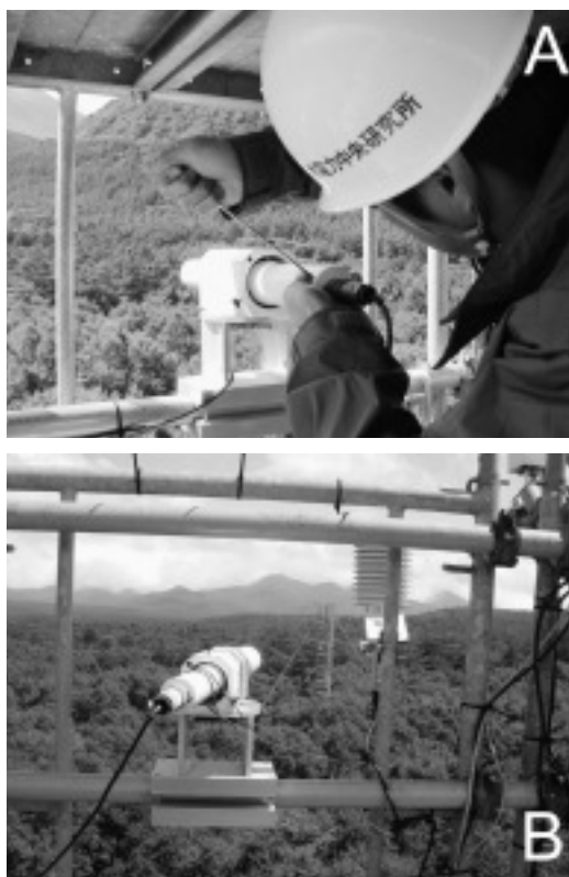
図 2.4 小口径シンチロメータ (DBSAS) の (A) 東側タワー (Tower-1) に設置したレシーバおよび (B) 西側タワー (Tower-2) に設置したトランスミッタから望む Tower-1。
