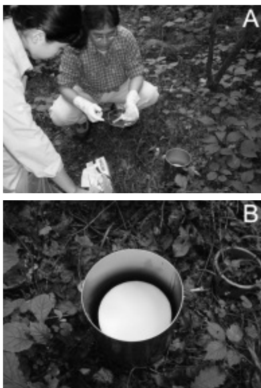
図 4.4 アルカリ吸収法による土壌呼吸量の測定。(A) 林床に設置したステンレス円筒内の \text{CO}_2 をアルカリ溶液に吸収させる。(B) 円筒内に設置されたアルカリ溶液を浸潤したスポンジ。
