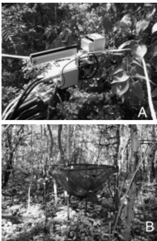
図 4.2 (A) リーフチャンバによる個葉の光合成反応の測定および (B) 林床に設置したリタートラップ。
