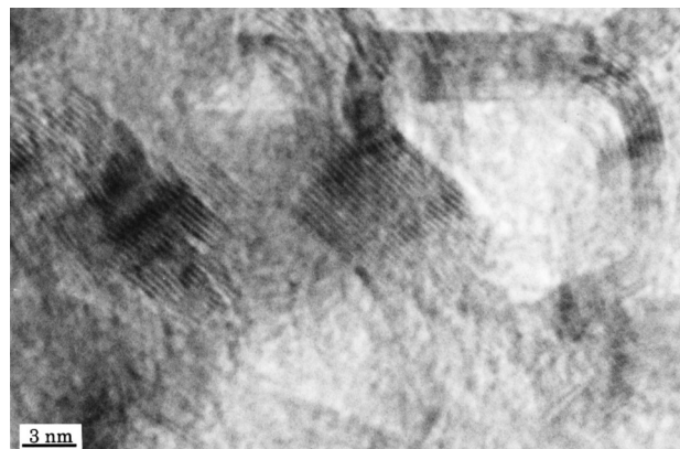
図 12：高分解能透過電子顕微鏡像。200°Cでの水質変成後に300°Cで熱変成させた試料。
