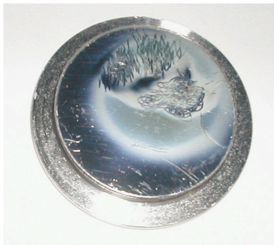
図4：光化学反応によってアルミニウム板の上に生成された有機物。アルミニウム板の直径は約3 cm。試料上部のひっかき痕は電子顕微鏡用の試料を採取したことによるもの。
