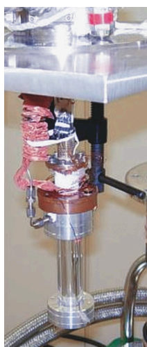
図 7：ヘリウムガスを圧力媒体とした約 0.1 GPa まで到達可能な中性子用ガス加圧装置のセル (単結晶サファイア)。長さ 8 センチメートル。
