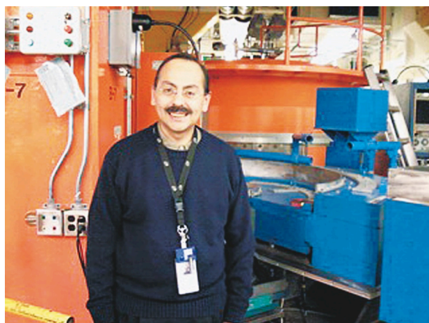
図1：米国オークリッジ国立研究所の研究用原子炉HFIRに設置した広角中性子回折装置（Wide-Angle Neutron Diffractometer: WAND）。青色の部分がWAND、オレンジ色の部分はHFIRの遮蔽体。図中の人物は、US-Japan Collaborationを担当するJ. A. Fernandez-Baca博士。
