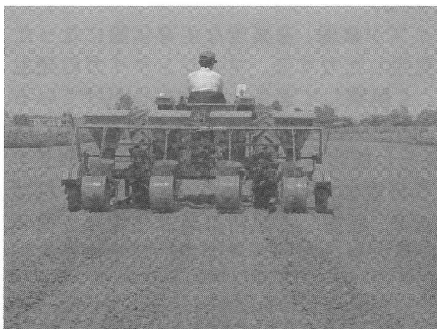
写真1.ビーンプランターによる播種風景
