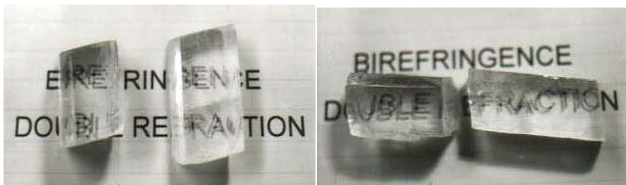
図 2.2 単軸結晶を通して見たときの文字の見え方 (複屈折) (a) (b)
