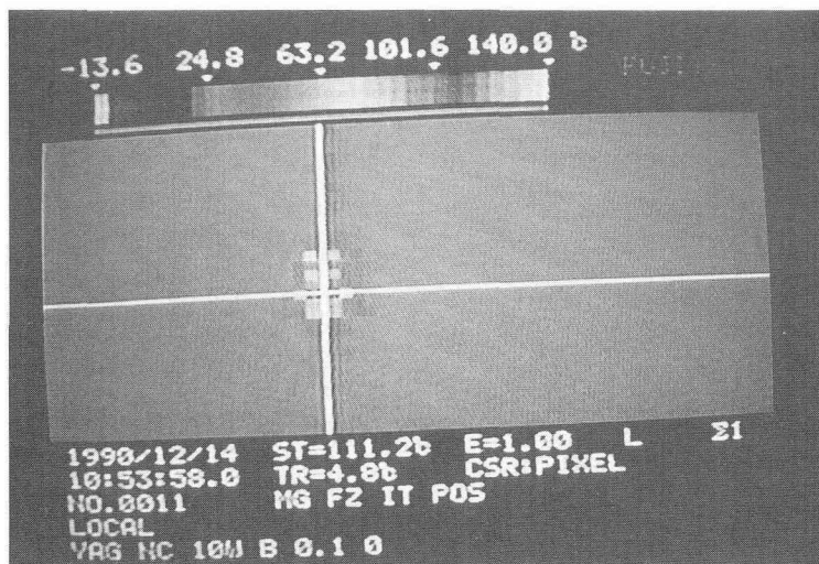
図12 サーモグラフィによるチューブ表面温度分布 (チューブB：非接触型 Nd-YAG レーザー照射 出力10W・0.1秒・距離0 cm で111.1℃に達した。)
