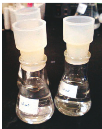
図 3: ゴム栓をした \text{NaHCO}_3^- 溶液. 密閉できていることが重要である.
