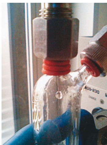
図7：ガスクロマトグラフのガラスセルに10 \mu\text{L} の \text{Na}_2\text{CO}_3 溶液をアプライする様子。シリンジのピストンを少しずつ下ろして先端に液滴を作り、それから一気に全部落とすと少量でも正確に測定が可能となる。
