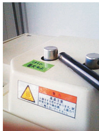
図 4: ガスクロマトグラフへの点火の様子. 点火口付近に火炎の先端を近づけて点火する. 点火できると「ボン」と音がする.
