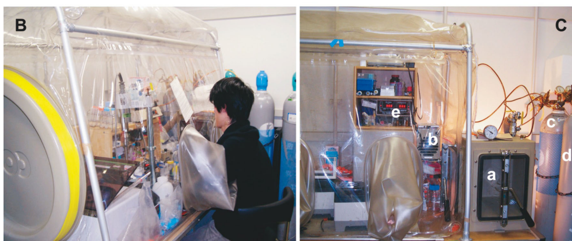
図1：嫌気チャンバー (A) 嫌気チャンバーの構成図。(B) 嫌気チャンバーで操作している著者。(C) 前室付近。a～eの記号は、Aと共通している。
