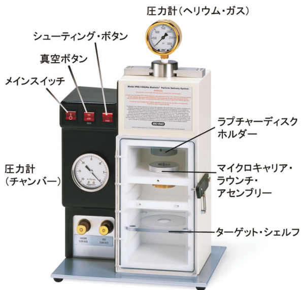
図6：遺伝子導入装置 PDS-1000/He. 写真はバイオ・ラッド・ラボラトリーズ社のご好意により提供していただいた。
