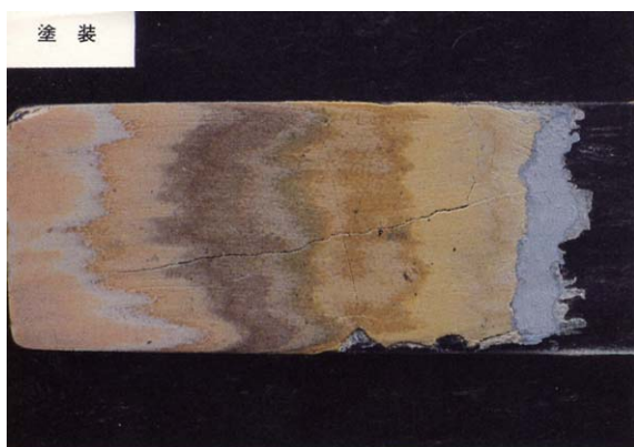
2. 当初塗装から修理前塗装までの塗剥サンプル
