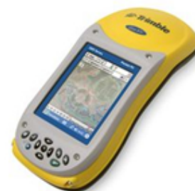
アメリカ・トリンブル社の GPS GEOXH 位置精度 1m以内 価格 100万円程度 (付属品、後処理ソフト込)
