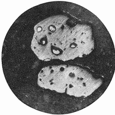
Fig. 35 Magnetic ilmenite from Notoro. ×120
