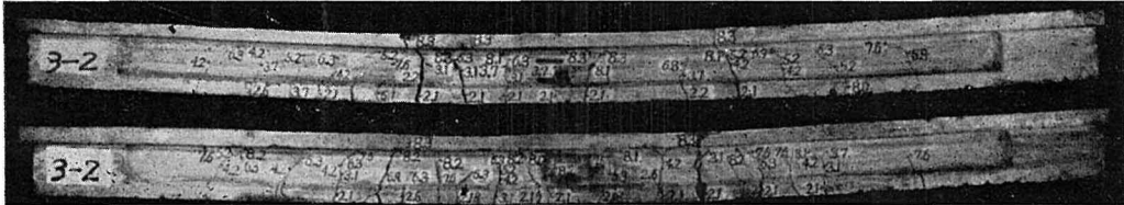
写真 5.16 RC 桁, No. 3-2, P_{cr}=2.10\text{ t} , P_B=8.27\text{ t} , \sigma_{cB}=408\text{ kg/cm}^2 , SS 41 丸鋼, カップラー継手
