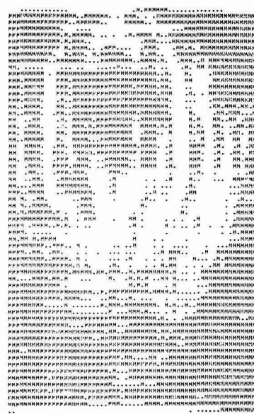
図6 計算機プリンターにより表示されたサンプルされデジタル化されたマイクロ波ホログラム
