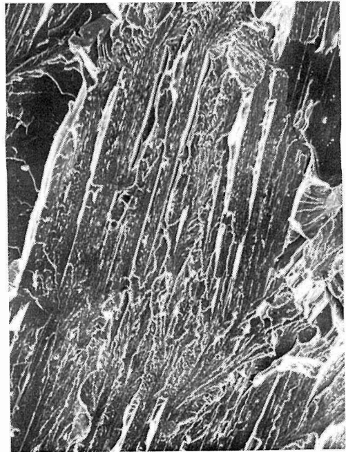
写真10 d=100\mu の破壊の伝播の様相 (SM 41 A)
