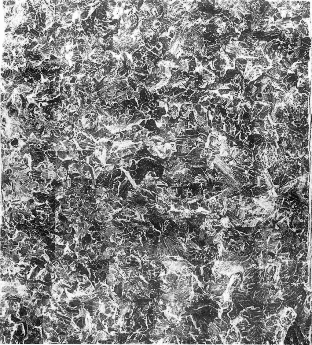
写真8 -196°Cにおける引張破断面の全面写真 ( d=200\ \mu , \rho=0.25\ \text{mm} )
