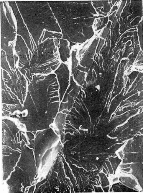
写真9 d=100\mu の破壊発生日点近傍 (SM 41 A)
