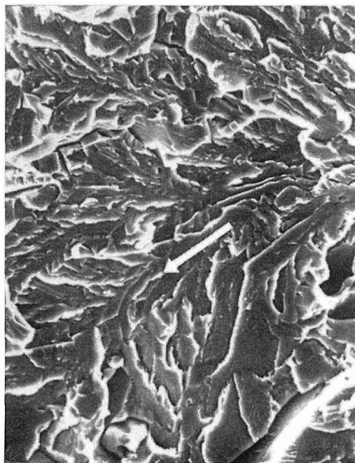
写真6 -196°CにおけるS 55 Cの脆性破面
