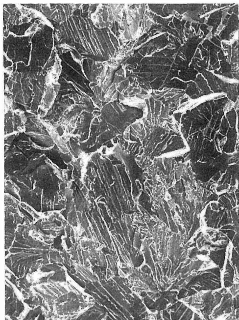
写真4 -196°CにおけるSM 41 Aの脆性破面
