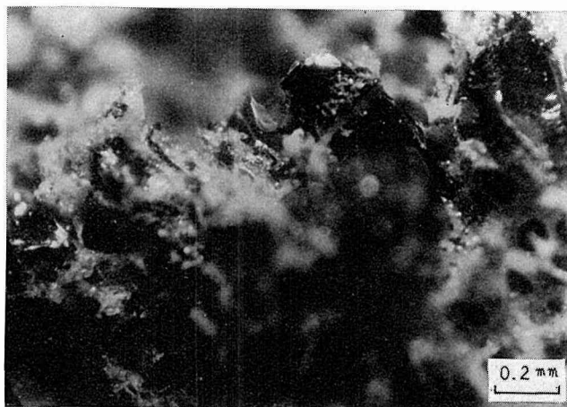
図 3-5 PVA 砥石の内部構造 (C 36 S 1 )
