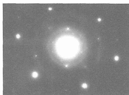
図 2 水素イオン注入を室温で 8.9 \times 10^{20} \text{ H}^+/\text{m}^2 まで行い、さらに 673 K で 5.5 \times 10^{21} \text{ H}^+/\text{m}^2 までイオン照射した JFMS 鋼の電子線回折パターン。
