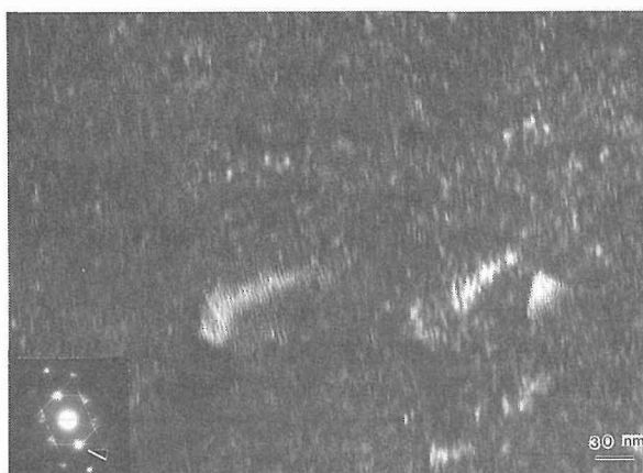
図10 室温で 2.0 \times 10^{20} \text{ H}^+/\text{m}^2 まで水素注入し、その後、673 K で 18 dpa まで電子線照射した JFMS 鋼における暗視野像。
