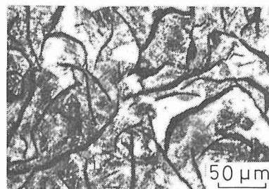
図1 片状黒鉛鑄鉄の顕微鏡組織
