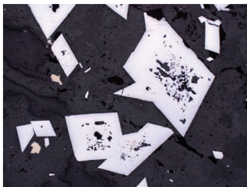
13 左：菱形を示す硫砒鉄鉱；右：正方形、長方形を示す黄鉄鉱
