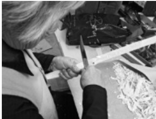
Illust.5 工程(4)でかんながけの代わりに ナイフで削る様子
