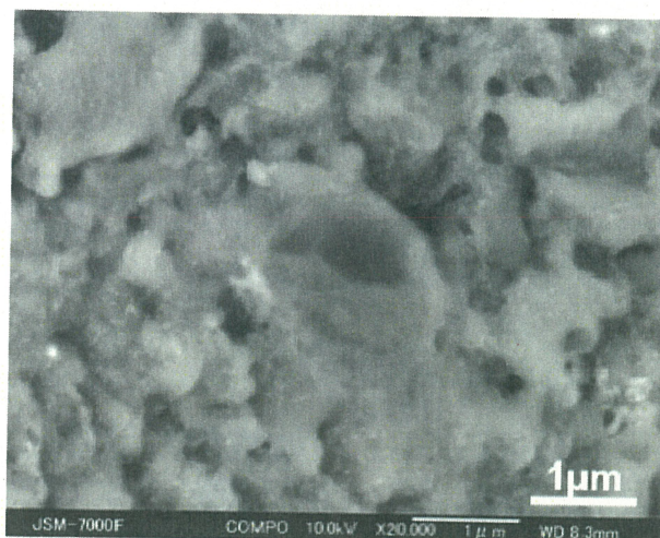
図6 図4の輝点部にある結晶の電子顕微鏡写真。この結晶は輝石と呼ばれる結晶である。
