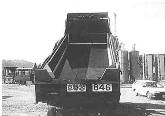
写真-3 運搬車の保温対策
