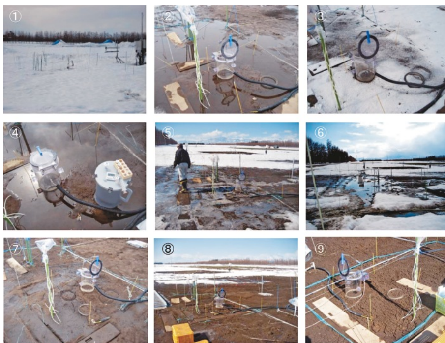
図 5：2009 年融雪期の除雪区の様子．① 3 月 20 日午後 1 時、10 cm 深 \text{O}_2 濃度低下中 (大気レベルの約 21% から約 17%) ② 3 月 28 日午後 4 時、 \text{O}_2 濃度低下中 (約 12%, 深夜にピーク) ③ 3 月 29 日午前 9 時、10 cm 深 \text{N}_2\text{O} 濃度最大値 (46 ppm) でこれ以後低下の一途、10 cm 深 \text{O}_2 濃度上昇中 (約 14%) ④ 3 月 29 日午後 1 時、10 cm 深 \text{O}_2 濃度上昇中 (約 15%) ⑤ 3 月 31 日午前 9 時、10 cm 深 \text{O}_2 濃度上昇中 (約 18%) ⑥ 3 月 31 日午後 3 時、10 cm 深 \text{O}_2 濃度上昇中 (約 19%) ⑦ 4 月 1 日午前 9 時 ⑧ 4 月 2 日午前 9 時 (同日 11 時の観測が最大 \text{N}_2\text{O} 放出速度)、10 cm 深 \text{O}_2 濃度ほぼ大気レベル ⑨ 4 月 8 日午前 9 時
