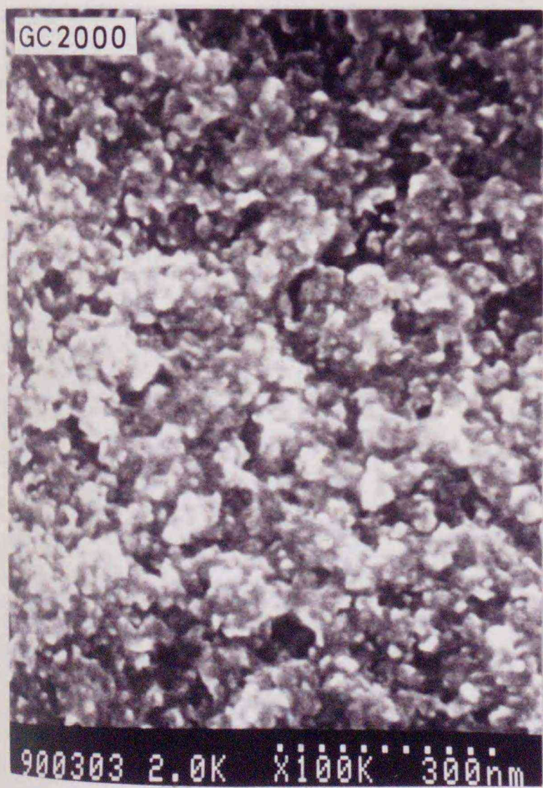
Fig. 3.2.2 GC-2000試料破断面の超高分解能SEM像
