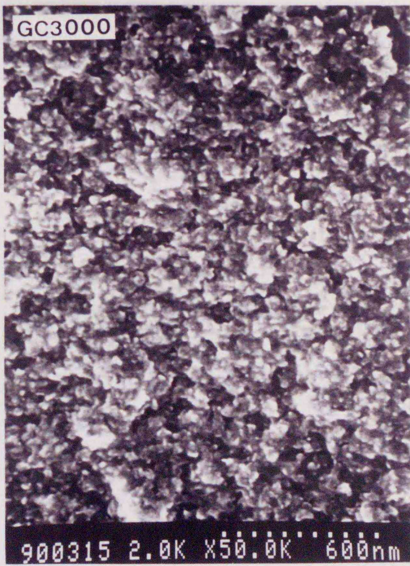
Fig. 3.2.3 GC - 3000 試料破断面の超高分解能 SEM 像
