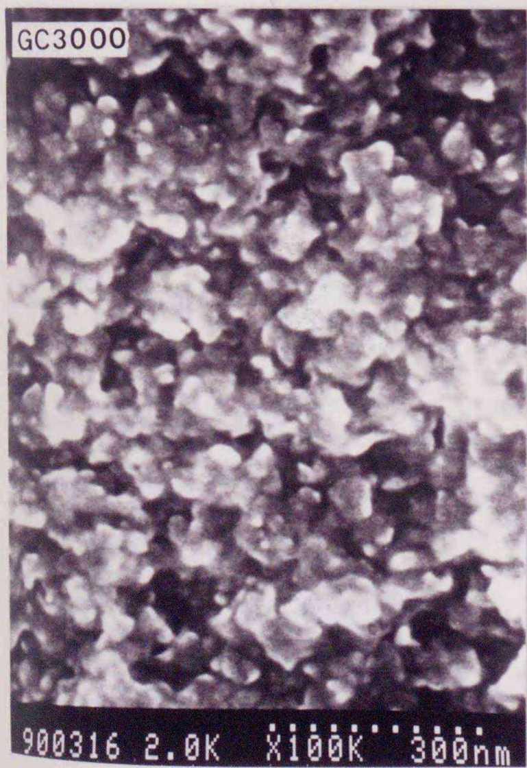
Fig. 3.2.3 GC - 3000 試料破断面の超高分解能 SEM 像
