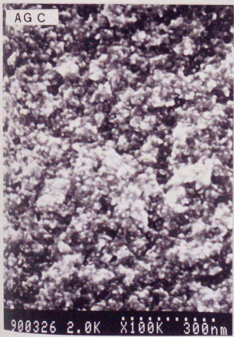
Fig. 3.2.4 AGC 試料破断面の超高分解能SEM像
