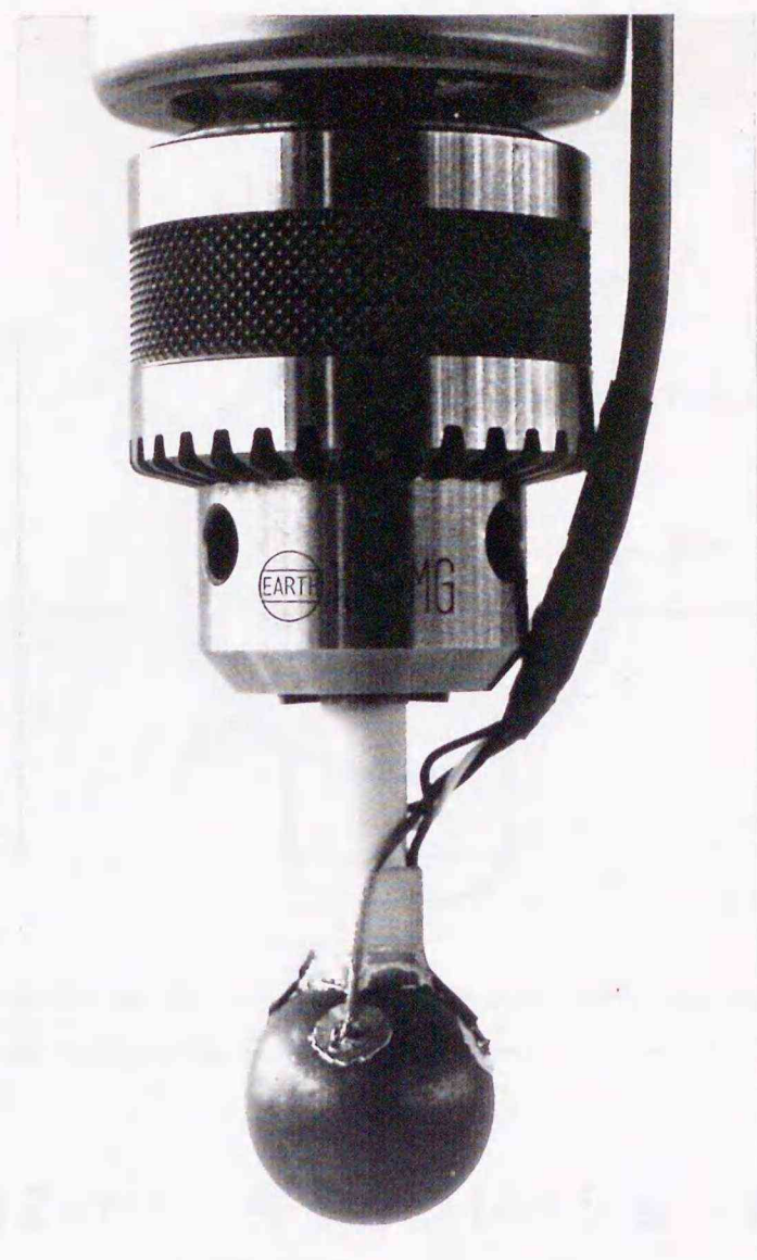
図2-10 試作した法線ベクトル検出基礎プローブ
